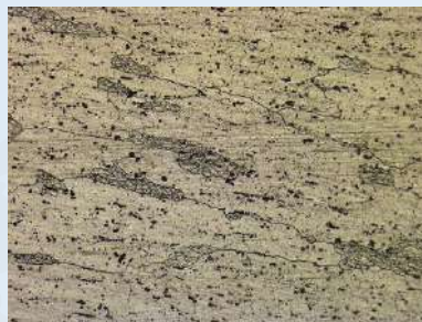
Microstructure of 6061 Alcoa 美铝车轮金相
